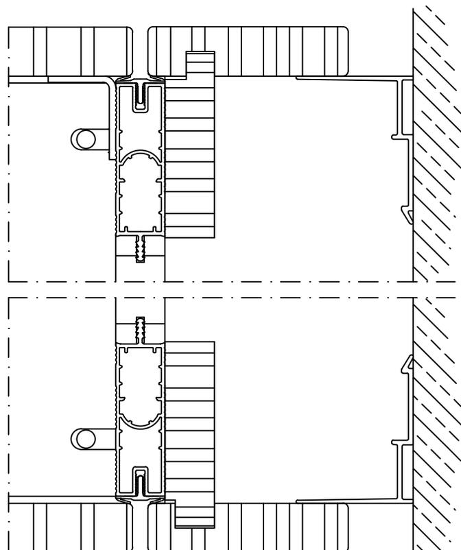
Horizontalschnitt Schrankanschluß an Ganzglaswand System 300
