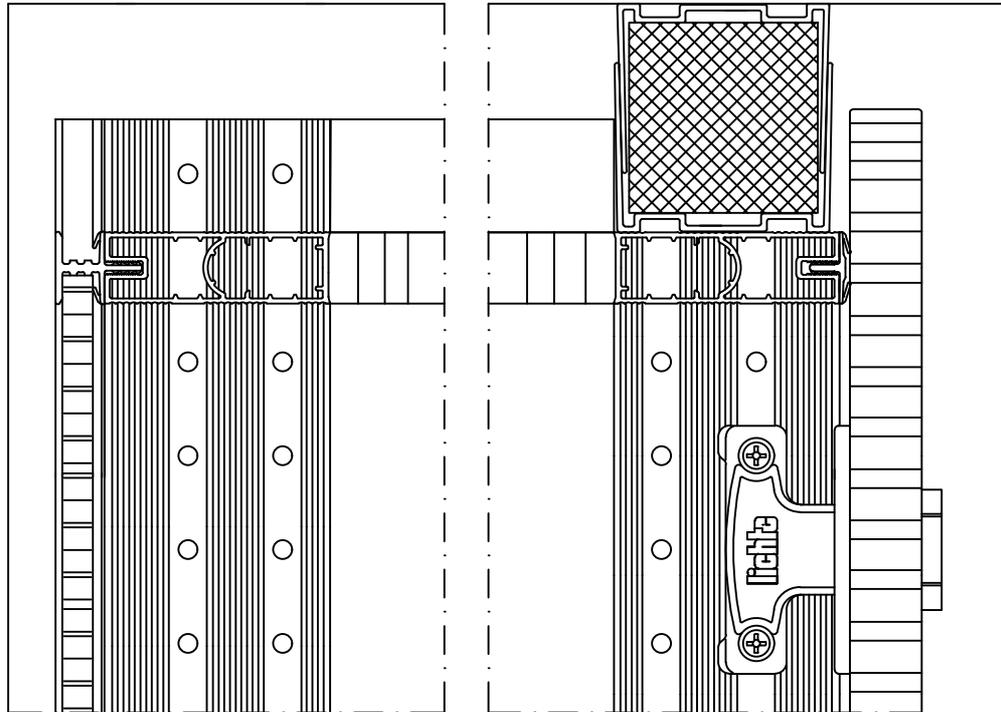
Raumtrennschrank, teleskopierender Deckenanschluß
